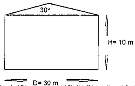
$\alpha_0 = 0,15 \times 10^{-2} \text{ } ^\circ\text{C}^{-1}$ , si el líquido se encuentra a  $15 \text{ } ^\circ\text{C}$  y la temperatura en el tanque puede llegar hasta los  $35 \text{ } ^\circ\text{C}$ . Se sabe que:  $V_{\text{final}} = V_{\text{inicial}} (1 + \alpha_0 \Delta t)$
